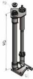
Gasausbläser GAB zur Entlüftung von PE-Gasleitungen
