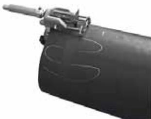
Dimensionsübergreifendes Schälgerät FWSG 225
