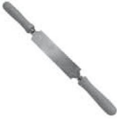
Zum Entfernen der Oxidschicht von PE-Großrohren, die nicht durch entsprechende Schälgeräte bearbeitet werden können. Insbesondere zur Vorbereitung von Sattelflächen für die Verarbeitung von FRIALEN XL Sattelformstücken. Ebenso geeignet zum Entgraten von Schnittkanten.
