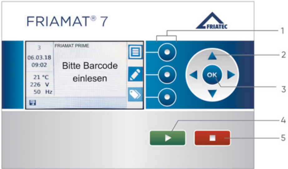
Abbildung 2: Beschreibung der Bedienkomponenten am Beispiel von FRIAMAT prime
